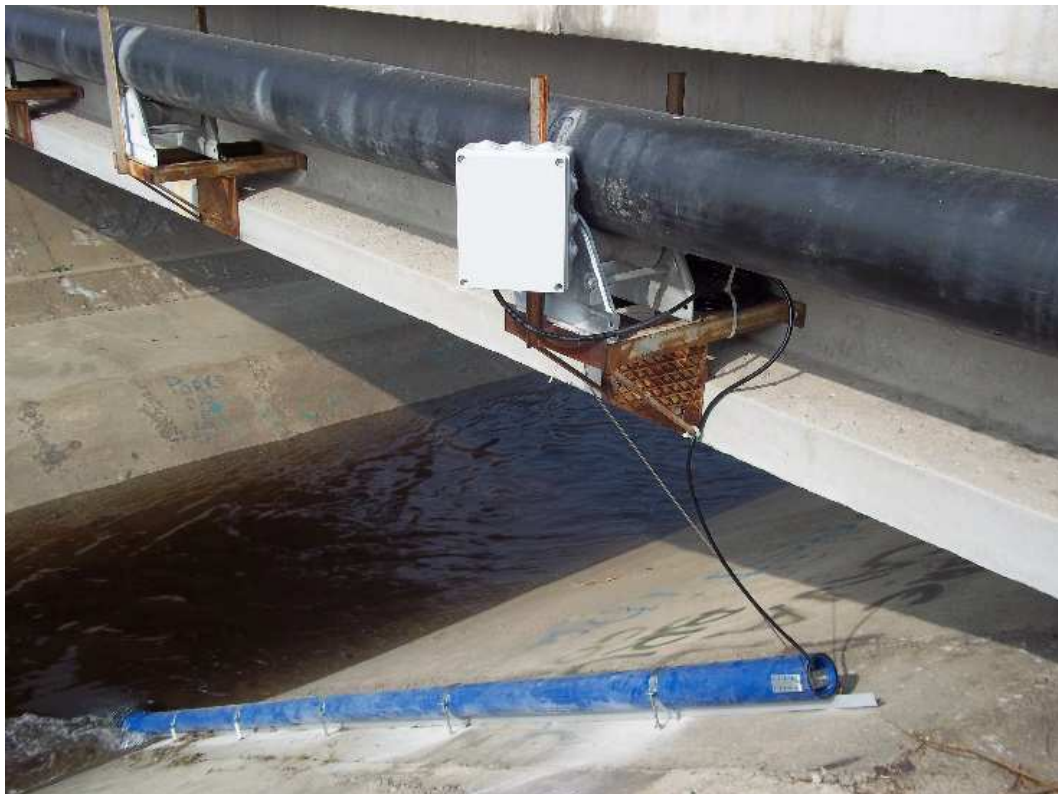
Figura 26 – Sonda multiparametrica YSI 6920 V2 della da YSI Inc.
