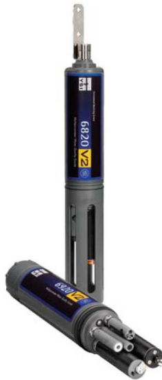
Figura 26 – Sonda multiparametrica YSI 6920 V2 della da YSI Inc.
