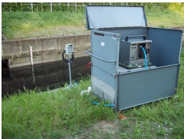
Figura 29 – Autocampionatore installato sul T. Seveso
