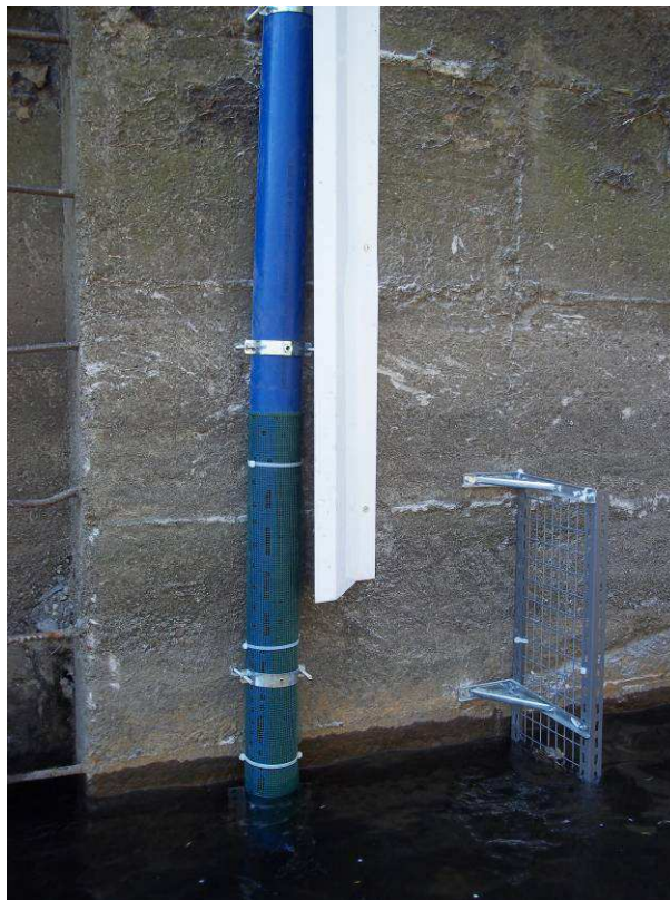
Figura 28 – Installazione della sonda S/N 13M101703 all’interno del T. Seveso
