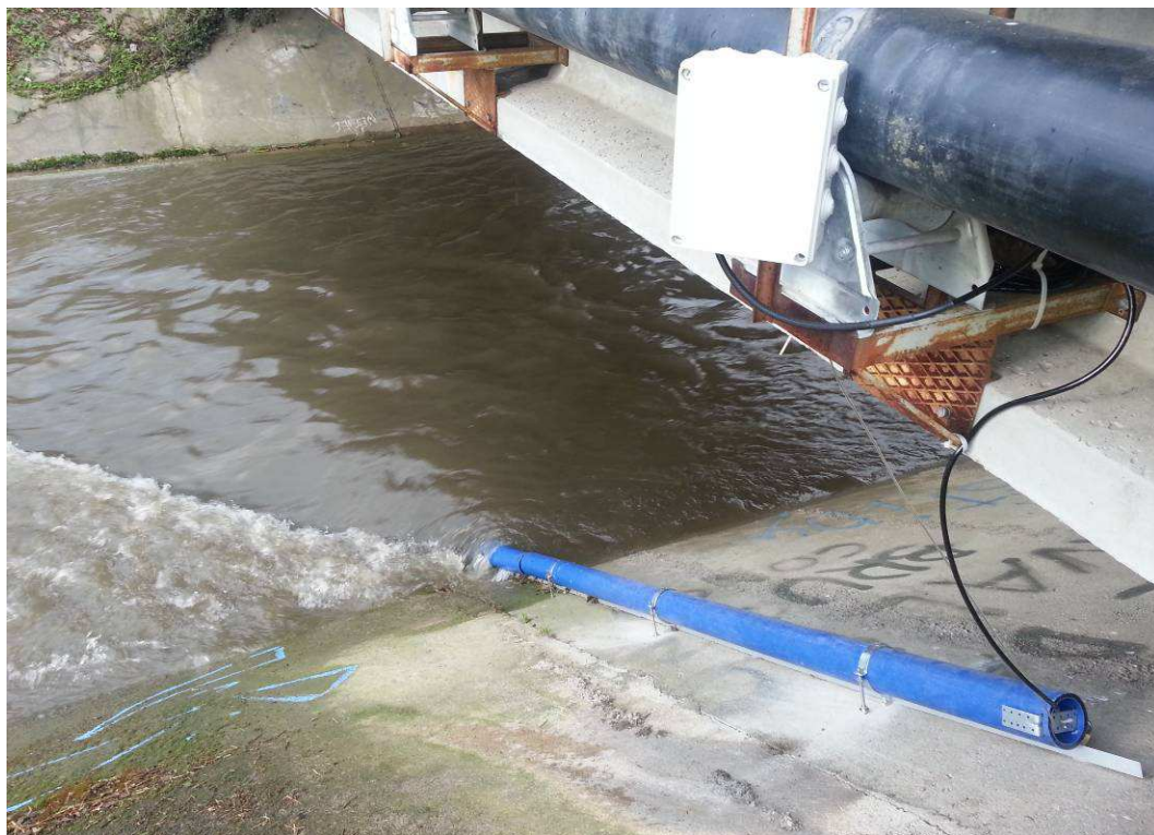
Figura 27 – Installazione della sonda S/N 13M101704 all'interno del CSNO
